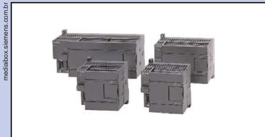
Fig. 20 – Controlador lógico programável Siemens.
